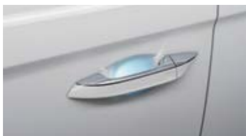
Podświetlane klamki zewnętrzne z dwukanałowym czujnikiem dotykowym
