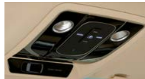
Konsola w podsufitce z kontrolkami zapięcia pasów bezpieczeństwa
